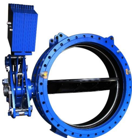
Ouverture par vérin hydraulique, fermeture par contrepoids
